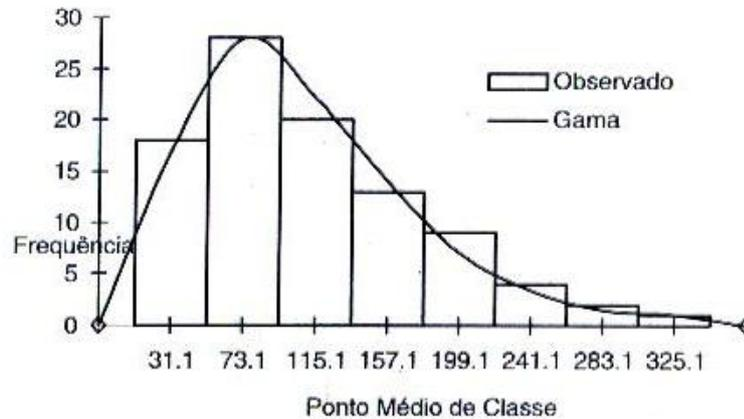
**Figura 6.** Totais de chuva mensal de *janeiro* em Pelotas, RS, ajustados a distribuição gama (Assis et al., 1996, pg. 59).
